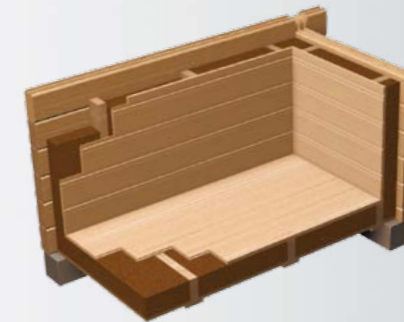
Двойная термо-стена Thermo wall inside
